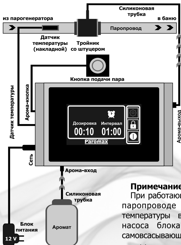
Рис. 2. Схема подключения диспенсера ароматов
